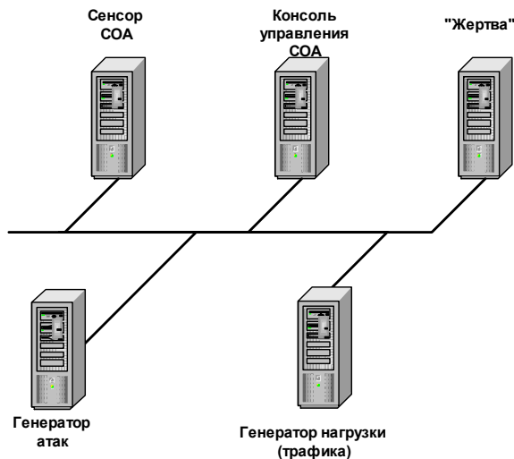
Рис. 1. Топология стенда для проведения тестов производительности
