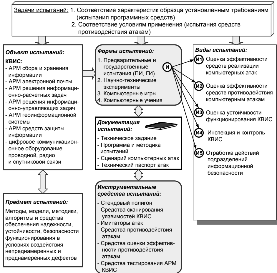
Рис. 1. Схема технологии испытаний КВИС в условиях компьютерных атак
