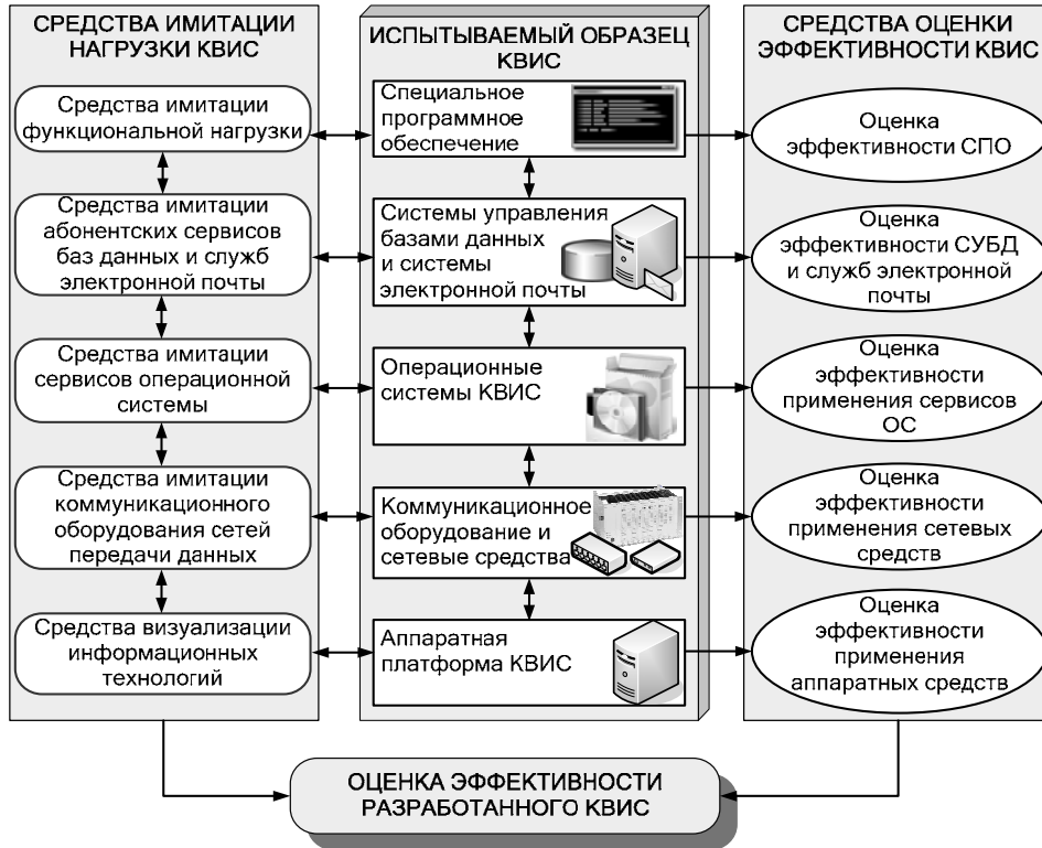
Рис. 2. Технологическая схема функционального тестирования КВИС
